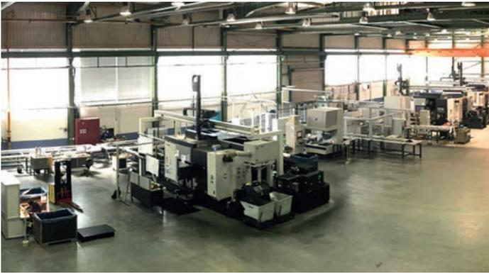
Bild 5: Verkettete Fertigungslinien bei Bharat Forge Daun
