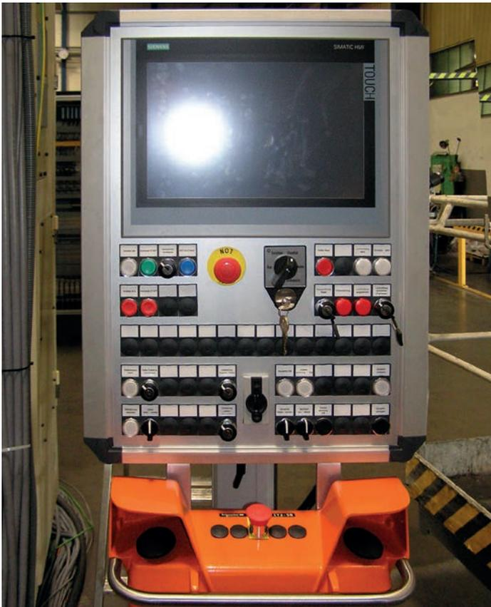
Bedienpanel der neuen Steuerung
