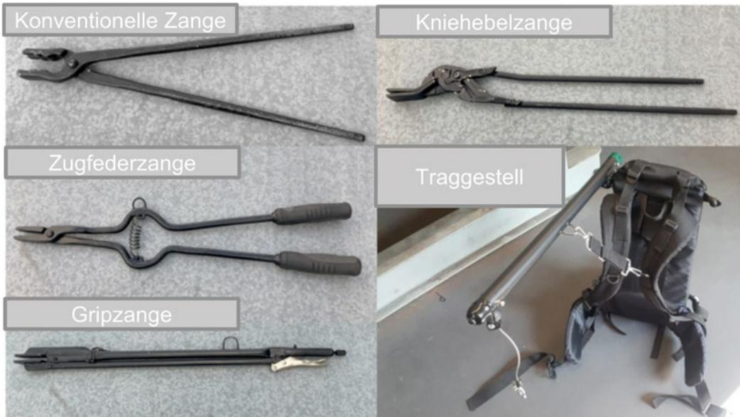
Bild 2: Konventionelle Schmiedezange, Prototypen der ergonomischen Schmiedezangen und des Traggestells, Bilder: Autoren
