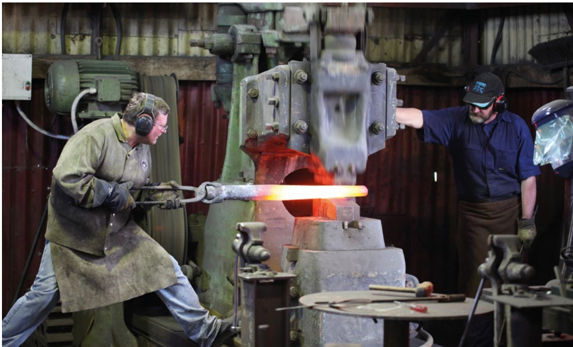
Schmieden der größeren Äste unter einem Bradley-Hammer
