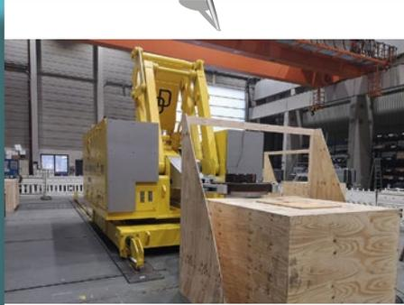
Der Schwerlastroboter legt die Werkstücke präzise im nachgebauten Ofen ab – gesteuert aus mehreren Tausend km Entfernung. Bild: Werksfoto Dango & Dienenthal Maschinenbau GmbH
