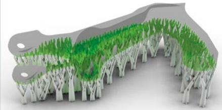
Simufact Additive nutzt in der neuen Version die Stützstrukturerstellung von CADS Additive. Bild: Hexagon
