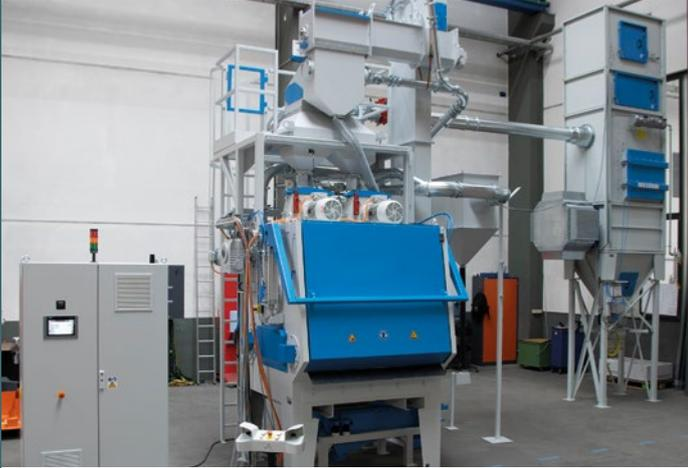
Die sonderlackierte und kundenspezifisch ausgestattete RMBC 4.2-HD sorgt für beschichtungsreif sauber gestrahlte Druckfedern. Bild: Rösler
