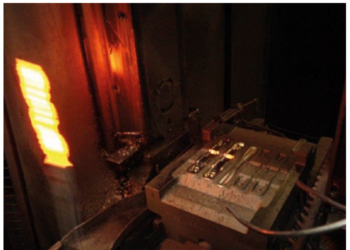
Bild 1: Definierte Werkzeugbeschichtung mit AquaNet 457 P/20 vor dem Schmiedeprozess (rechts) und nach dem Schmiedeprozess(links). Bild: HEYCO-WERK Süd Heynen GmbH & Co. KG.
