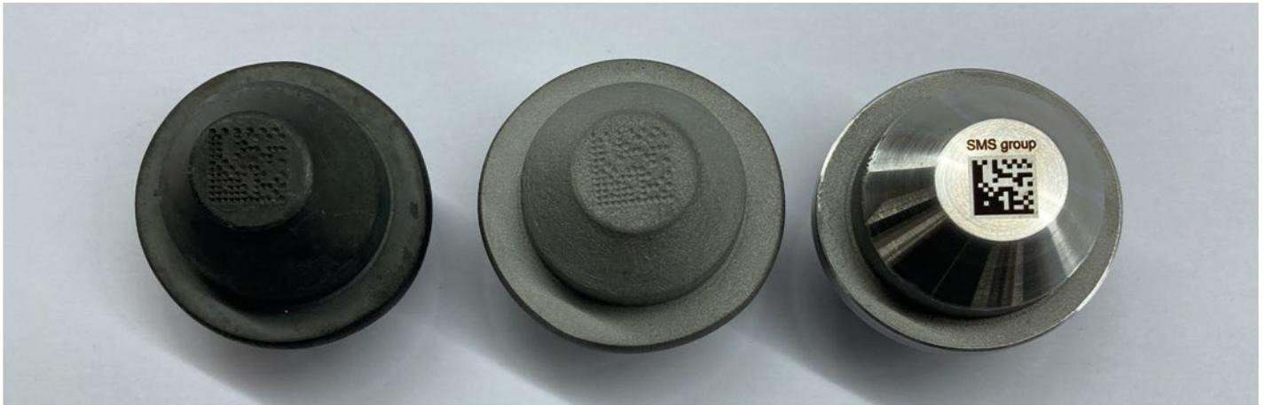
Der nadelgeprägte Code übersteht alle Bearbeitungsschritte. links: geschmiedetes Teil mit Data-Matrix-Code, Mitte: nach dem Sandstrahlen; rechts: mechanisch bearbeitetes Teil mit Laser-Code
