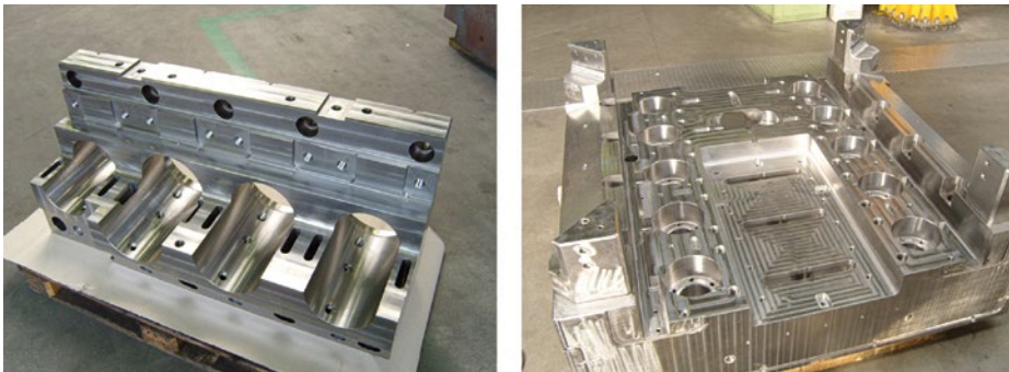
Bild 1: Werkzeughalter in kundenspezifischer Ausführung: Hatebur-Amboss und Kassettenhalter
