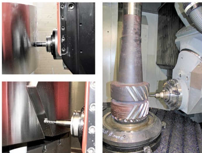
Bild 4: 5-Achsfräsen von Verzahnungen
