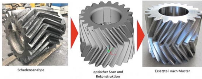
Bild 3: Anwendungsbeispiel Ritzel (Modul 20, 20 Zähne, Kopfkreisdurchmesser 492 mm, Verzahnungsbreite 410 mm)
