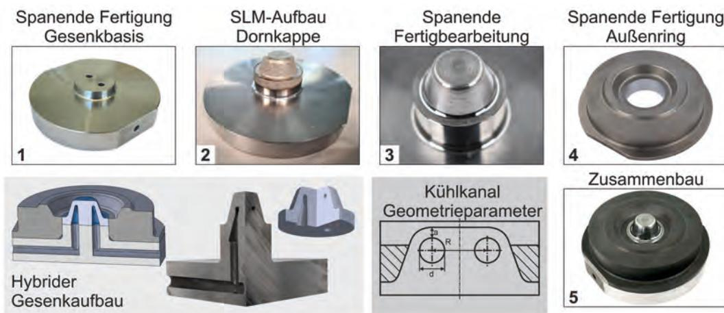
Bild 1: Hybrider Gesenkaufbau und Herstellroute
