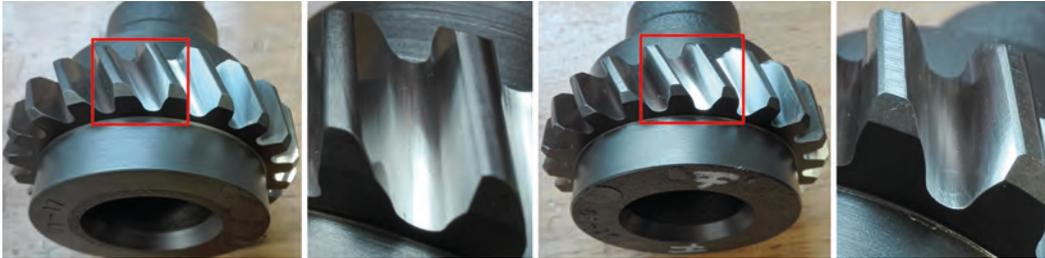
Bild 3: Fertigverzahnte Demonstratoren D1 – warmgewalzt/einsatzgehärtet und geschliffen (links) sowie gefräst/einsatzgehärtet und geschliffen (rechts)
