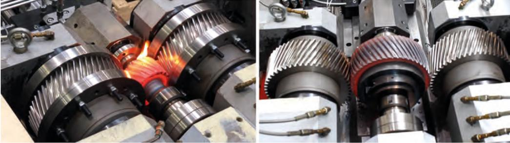
Bild 1: Warmwalzprozesse D1 – Welle (links) sowie D2 – Losrad (rechts)
