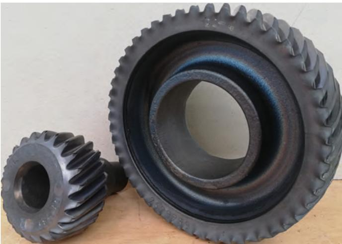
Bild 2: Warmgewalzte Demonstratoren D1 – m4 z22 (links) sowie D2 – m4 z49 (rechts)
