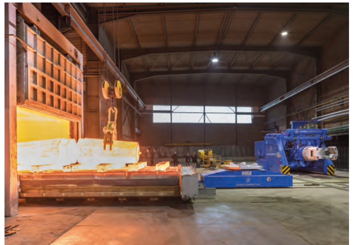
Das Digitale Werkzeug sichert die hohe Produktivität der schienengebundenen Schiedemanipulatoren, Bilder: Werksfotos DANGO & DIENENTHAL
