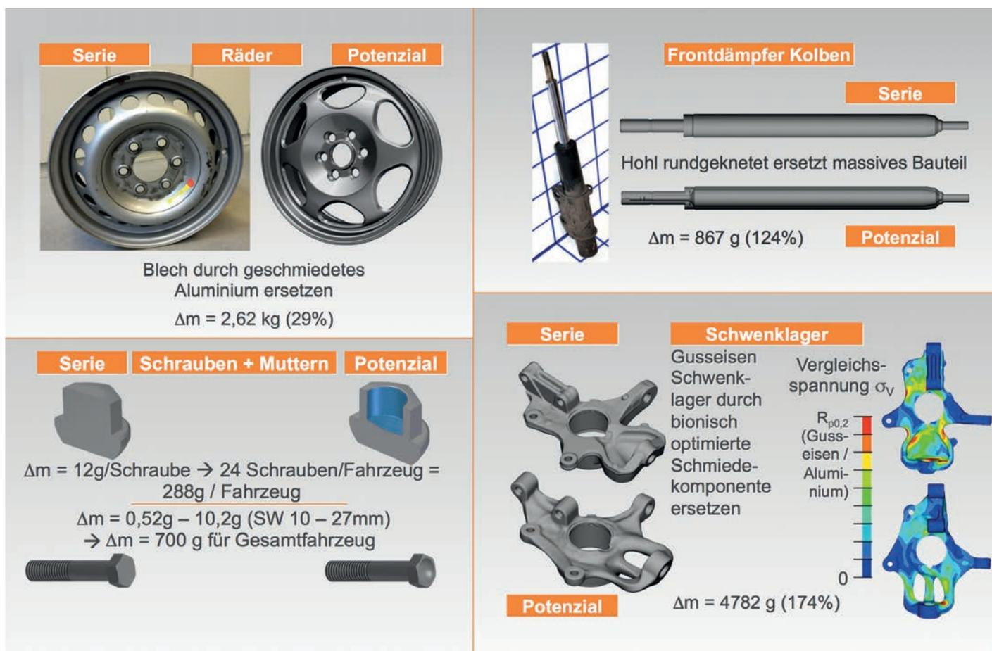
Bild 4: Leichtbaupotenzial im Fahrwerk – überwiegend Vorderachse.
