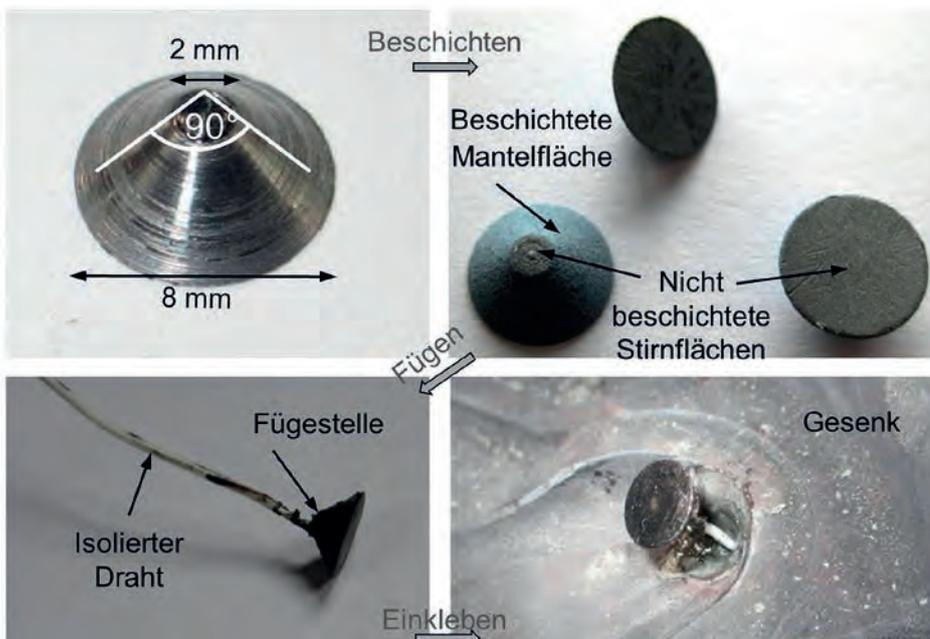
Bild 2: Geometrie und Einbau der Kegelemente.
