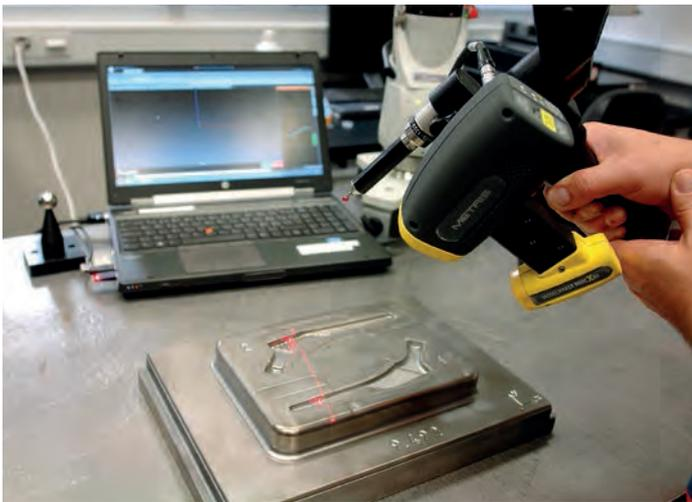
Bild 3: Geometrische Freigabe eines Gesenks für eine Hüftprothese.
