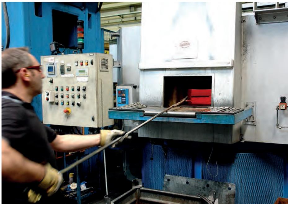
Bild 1: Mehrfach werden die Schmiedeteile bis zur endgültigen Formgebung im Ofen erwärmt.
