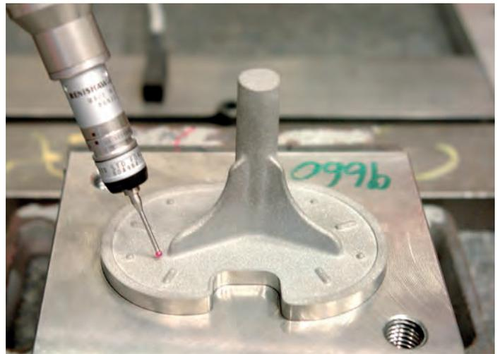
Bild 4: Freigabemessung eines Tibiaplateaus für eine Knieprothese. Bilder: Autor
