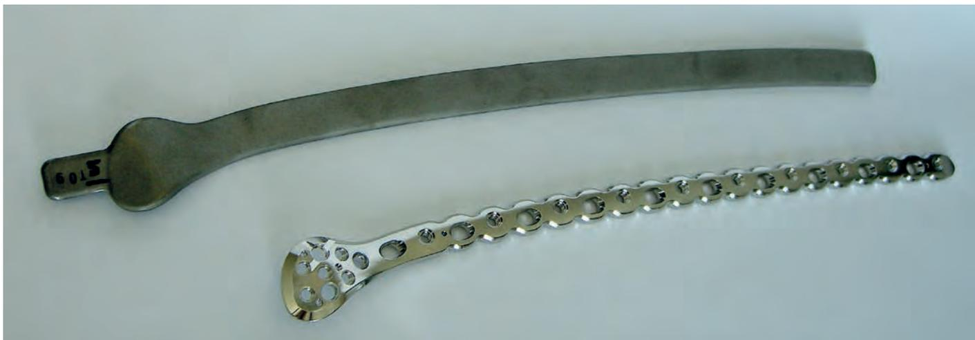
Bild 7: Vergleich zwischen Rohteil und OP-fertigem Bauteil einer Femurplatte distal lateral.
