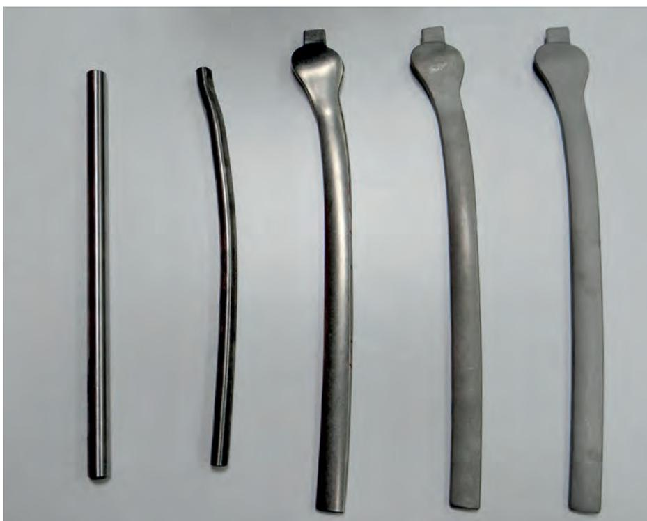
Bild 2: Stadiengang einer geschmiedeten Femurplatte: Sägeabschnitt, Biegen, Schmiederohling entgratet, geschliffen und gestrahlt (Fertigteil).
