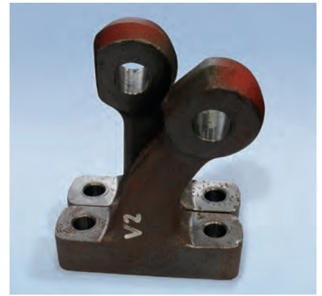
Bild 3: Duktil verbogener Lenkhebel nach Impactversuch.
