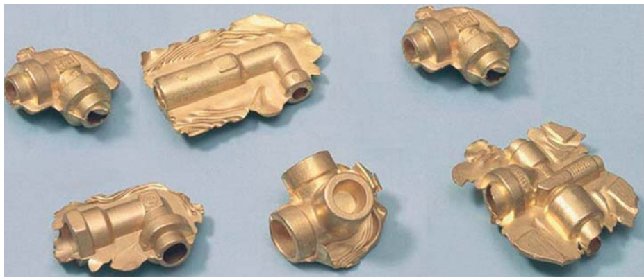
Bild 1: Beispiele für Schmiedestücke mit Grat.
