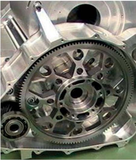
Bild 3: Einstufiges Stirradgetriebe.
