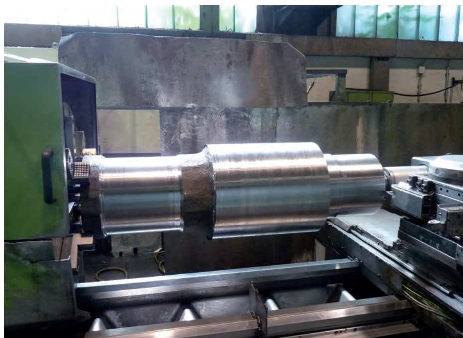
Bild 2: Produktion einer Planetenwelle für Off-Shore-Windanlagen: Unternehmen der Metallverarbeitung fürchten steigende Stromkosten, profitieren aber auch vom Ausbau der Erneuerbaren Energien. Bild: Karl Diederichs KG
