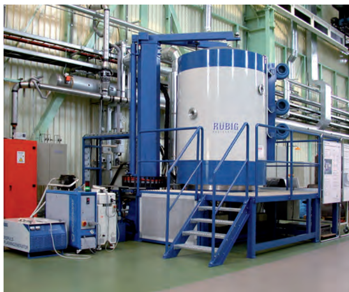
Bild 1: Beschichtungsanlage PN 100/150 der Rübigen Anlagentechnik.
