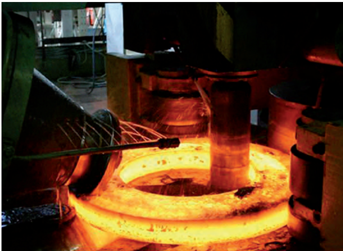
Bild 2: Flexibles axiales Profilieren und Werkzeugkonzept. Das Ergebnis sind scheibenförmige Ringe ein- und mehrstufig axial profiliert [4].
