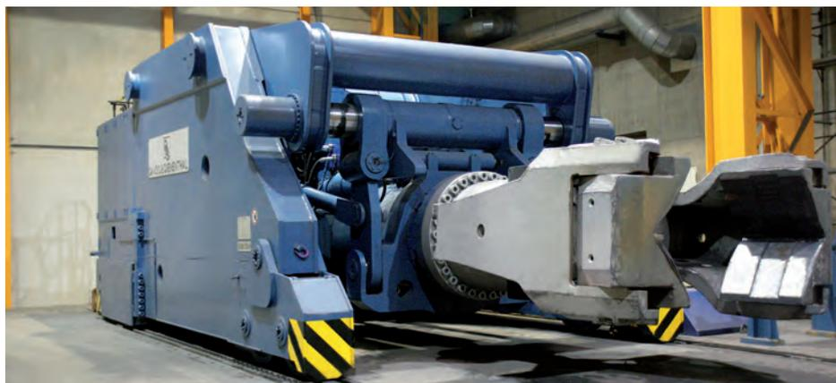
Bild 8: Der neue Schmiedemanipulator mit einer Tragkraft von 250 Metertonnen kann einen 100 t schweren Schmiedeblock ohne Unterstützung frei tragen.
