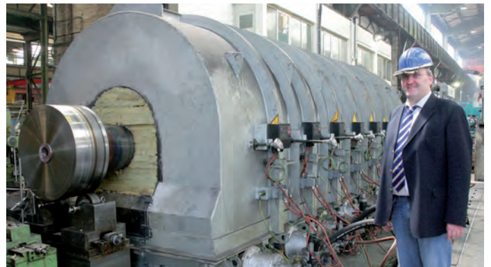
Bild 12: Im Warmlauf-Prüfstand rotieren Turbinenwellen über mehrere Tage bei Betriebstemperatur, während Sensoren alle Anzeichen für Formänderungen oder Verlagerungen überwachen. Bilder: Klaus Vollrath
