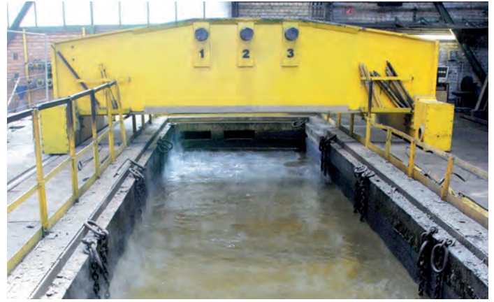
Bild 10: Für das Abschrecken verwendet man statt des umweltbelastenden und feuergefährlichen Öls wässrige Polymerkühlmedien.
