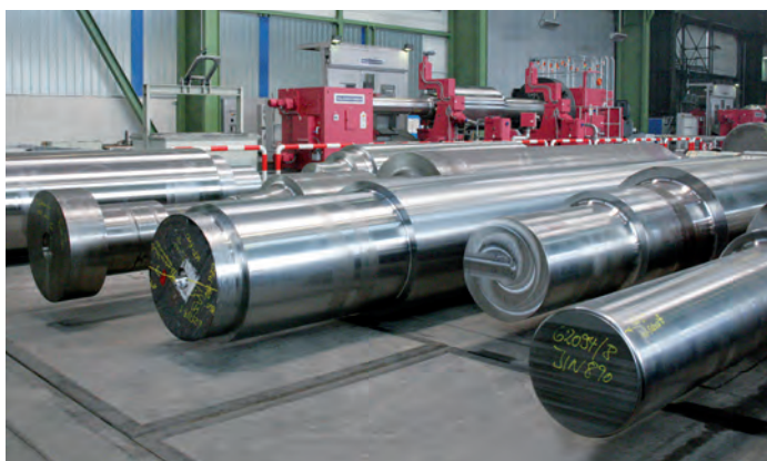
Bild 3: Die Fertigung von freiformgeschmiedeten Wellen und Rotoren für den Kraftwerkbereich ist ein Spezialgebiet der Buderus Edelstahl GmbH.
