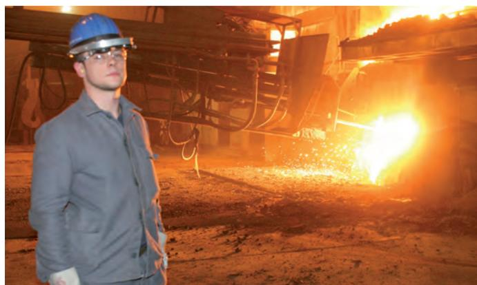
Bild 4: Primäres Schmelzaggregat ist ein Elektrolichtbogenofen mit einem Fassungsvermögen von bis zu 140 t, der als Besonderheit einen schlackenfreien Abstich aufweist.
