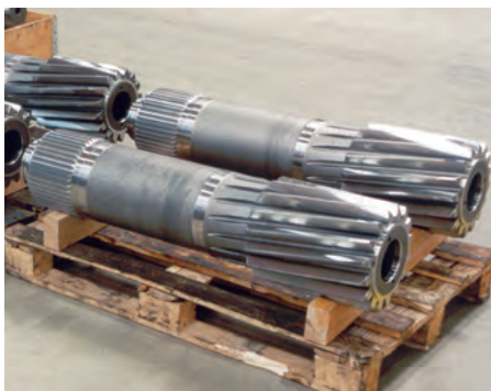
Bild 2: Verzahnungsteile, hier eine Sonnenwelle für das Planetengetriebe einer Windenergieanlage, werden aus geschmiedetem Stabstahl gefertigt.
