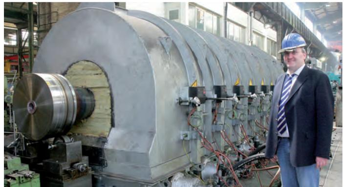
Bild 12: Im Warmlauf-Prüfstand rotieren Turbinenwellen über mehrere Tage bei Betriebstemperatur, während Sensoren alle Anzeichen für Formänderungen oder Verlagerungen überwachen.
