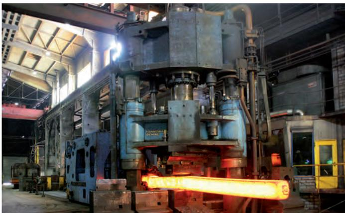
Bild 5: Eine Freiform-Schmiedepresse im Einsatz.
