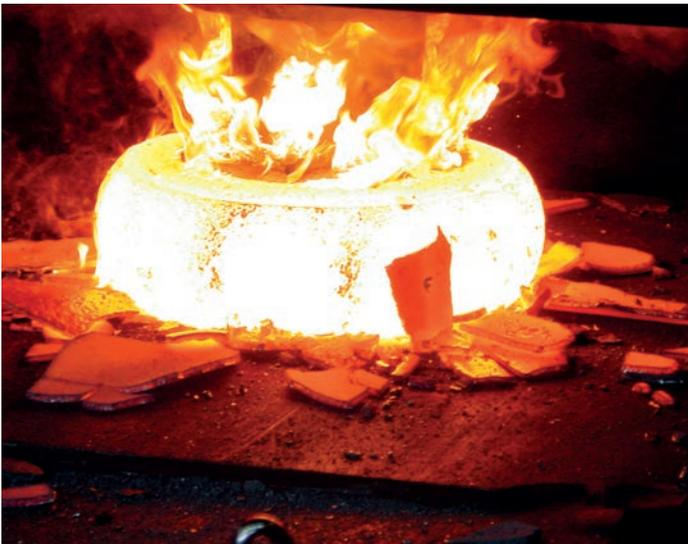
Bild 2: Ein nicht hydraulisch entzunderter Rohling für das Ringwalzen in der Presse nach dem Stauchen.
