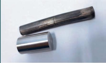
Anfangsform für die Kaltumformung und fließgepresstes Formteil,
