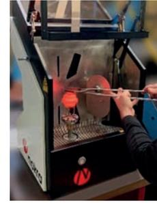
Warme Schmiedestücke werden unmittelbar nach dem Verlassen der Schmiedepresse direkt vom Förderband in die Messzelle eingesetzt, Bild: nokra GmbH
