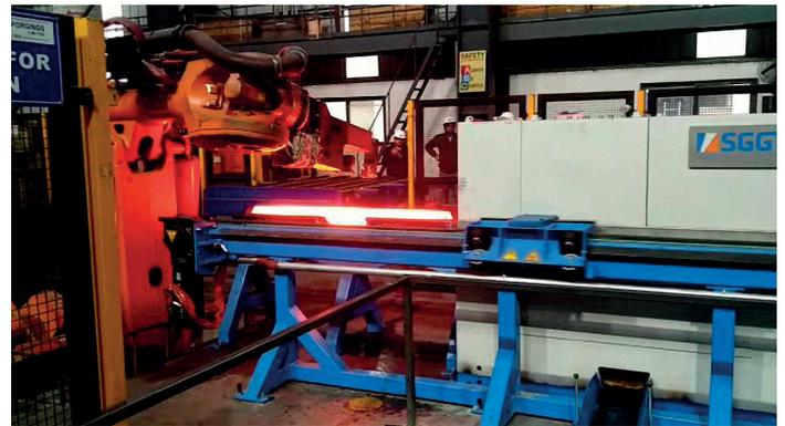
Bild 1: Transfer der Knüppel vom Induktor zur Entzunderung (links) und Übernahme des Knüppels nach dem Entzundern durch den Roboterarm (rechts)
