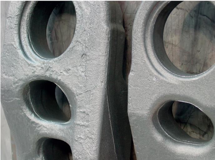
Bild 3: Vergleich von Schmiedeteilen ohne (links) und mit Entzunderung (rechts)
