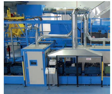
Bild 2: Horizontale 6 Stufen-Kaltumformpresse mit 9.000 kN Presskraft.
