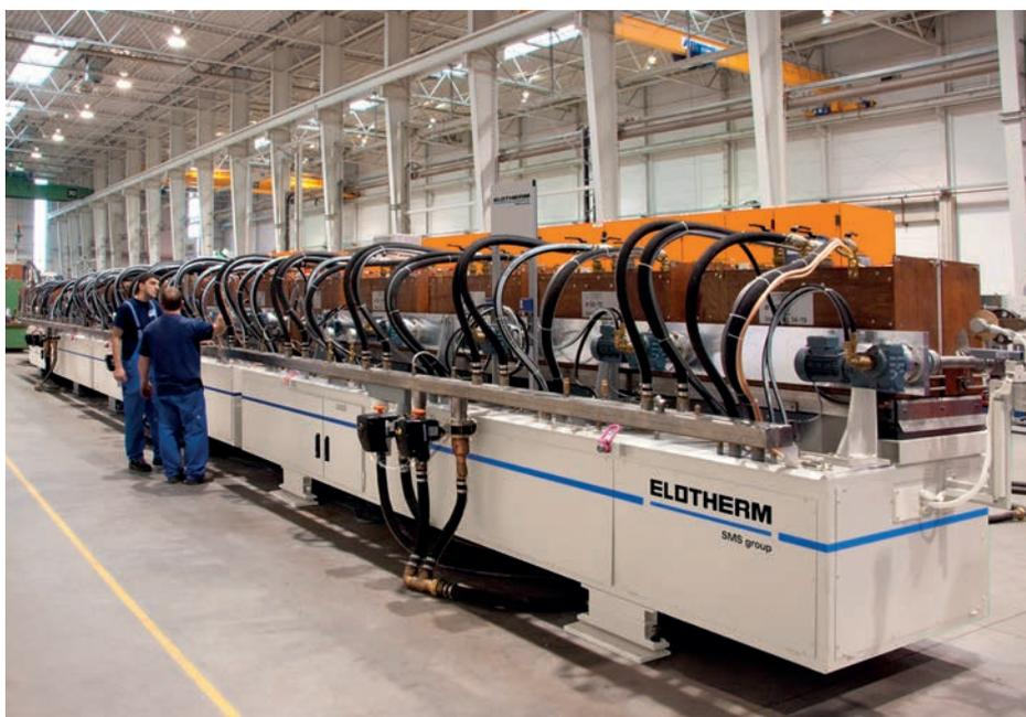
Bild 2: Stangenerwärmungsanlage für die flexible Produktion.
