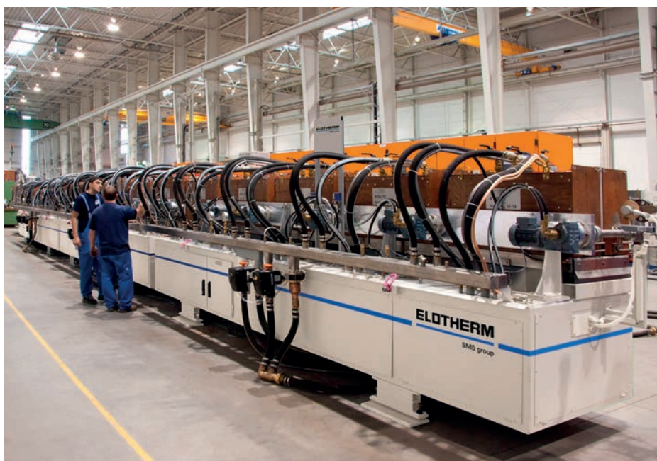
Bild 2: Stangenerwärmungsanlage für die flexible Produktion.
