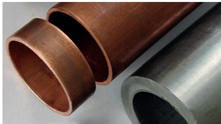
Bild 4: Trennergebnis bei Massivstäben (C45), Kupferrohr (hart) und Stahlrohr (34MnB5) sowie Walzprofil (ZStE340) [6].
