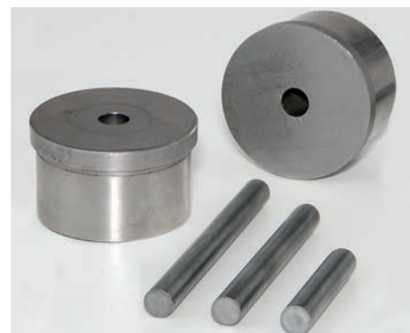
Bild 2: Werkzeugpaar (Matrizen) und getrennte Stäbe [5].
