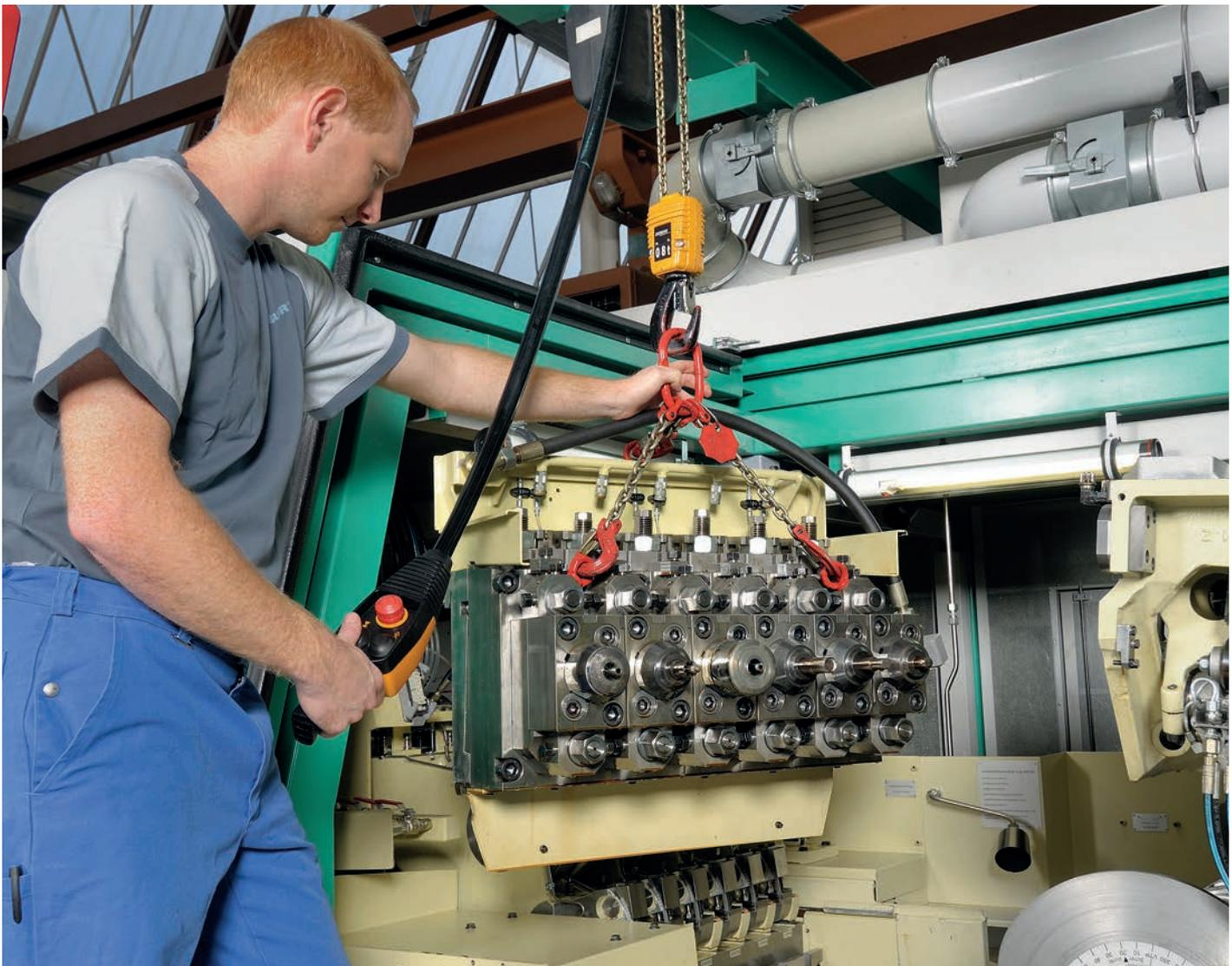
Bild 6: Schnellwechsellkassetten mit Stangenmesser und Führungsbüchsen erleichtern das Umrüsten und reduzieren die Stillstandzeiten beim Produktwechsel. Bild: Hatebur
