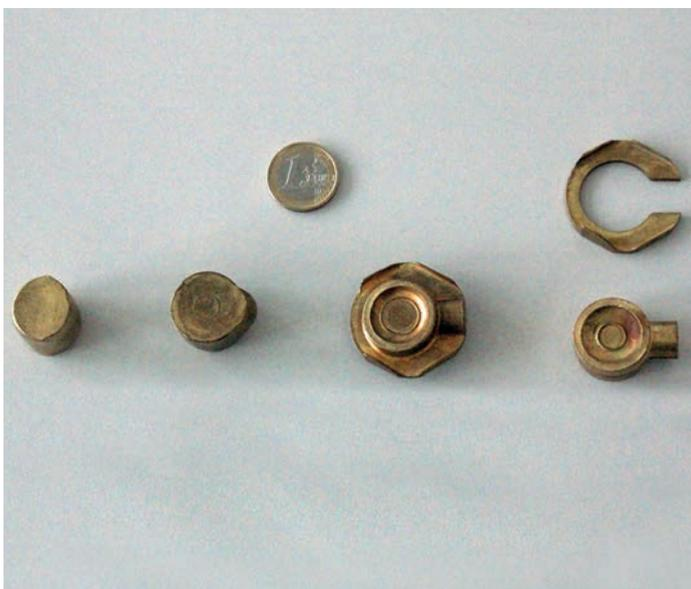
Bild 7: In drei Stufen umgeformtes Messing-Schmiedeteil: Links der Scherling, rechts das fertige Teil, darüber der abgetrennte Schmiedegrad.
