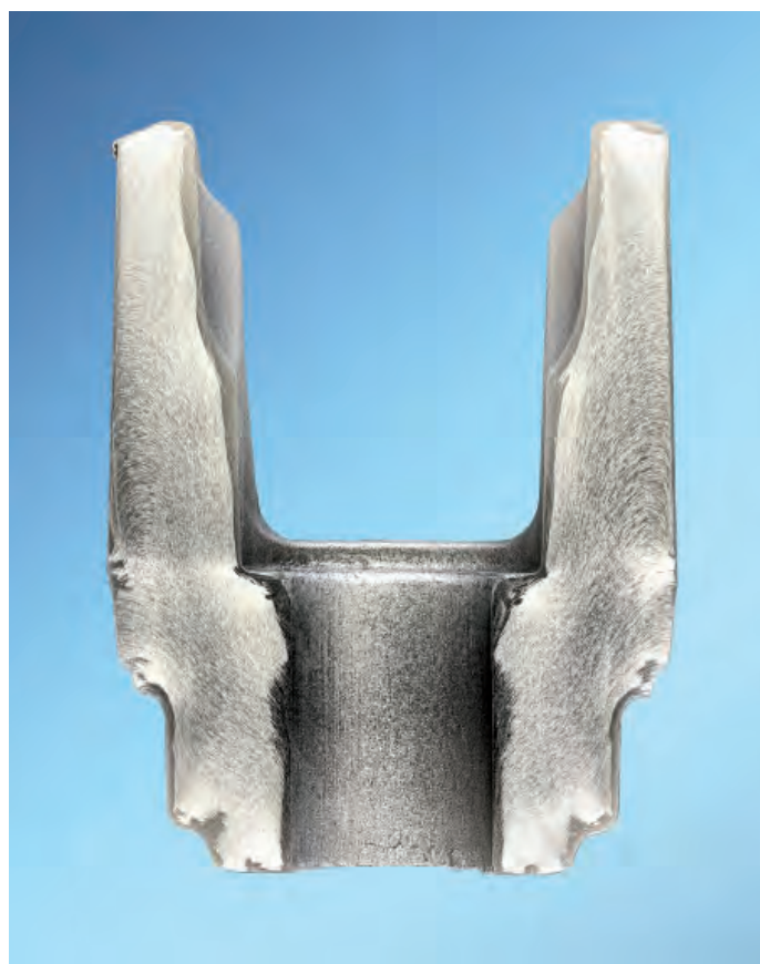
Bild 9: Belastungsoptimierte Orientierung des Faserverlaufs zur Erhöhung der Betriebsfestigkeit eines typischen Elementes aus dem Antriebstrang eines Pkw.
