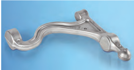
Bild 3: Unterer Querlenker einer Sportlimousine. Die filigrane Ausführung trägt dazu bei, das Gesamtgewicht des Fahrzeugs auf weniger als 2 t zu begrenzen.
