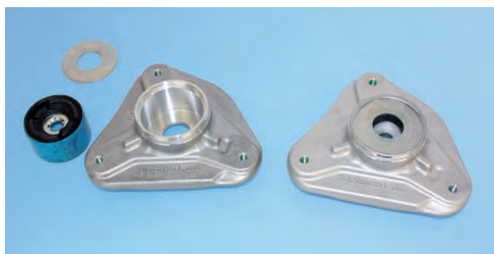
Bild 8: Umformbarkeit als Trumpf: Stützlager aus Schmiedeteil, Gummilager und Abdeckscheibe. Rechts die fertig montierte Baugruppe nach dem Einpressen des Lagers, dem Aufsetzen der Scheibe und dem Einbördeln des Randes.
