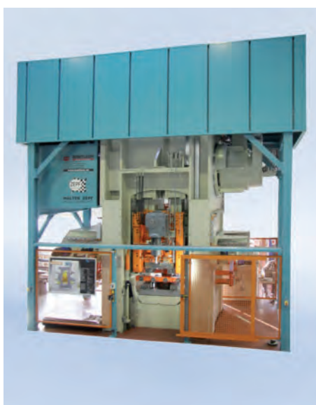
Bild 4: Exzenterpresse der Firma Müller Weingarten (PK1000S-Speedforge) am IFUM. Bilder: Autoren
