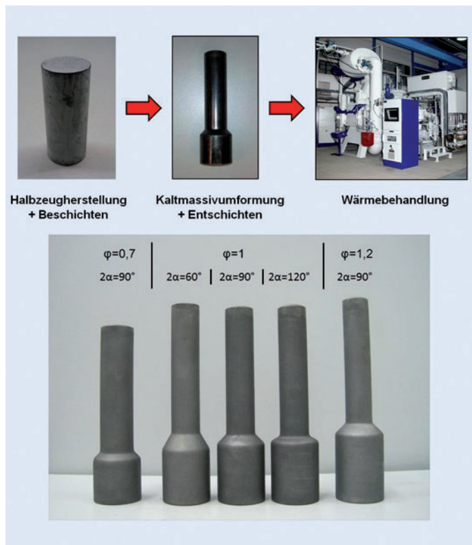
Bild 2: Grundlegende Prozesskette (oben) und Geometrievariationen durch Änderung von Umformgrad und Öffnungswinkel (unten).
