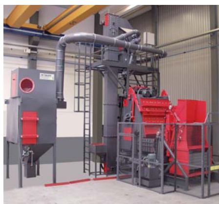
Bild 5: Die RMBC 8.2 in Schwerlast-Ausführung ist mit zwei wartungsfreundlichen Hochleistungs-Schleuderrädern mit jeweils 22 kW Antriebsleistung ausgestattet. Sie bieten die erforderliche Leistung um bis zu 8 Tonnen Schmiedeteile in einer Stunde zu bearbeiten.
