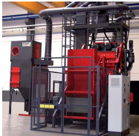
Bild 3: Die Beschickung der Muldenband-Chargenstrahlanlage erfolgt durch ein Doppelkippsystem. Es gewährleistet die 100-prozentige Entleerung der Transportbehälter.
