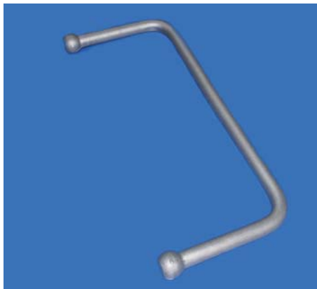
Bild 2: Das Entzundern und Entrosten von Schmiedeteilen wie diesem Träger der Vorderachse erfolgt in der Rösler RHBD. Nach der mechanischen Bearbeitung kann in der Anlage auch ein Shotpeening zur Verdichtung der Oberflächen durchgeführt werden. Bilder: Rösler
