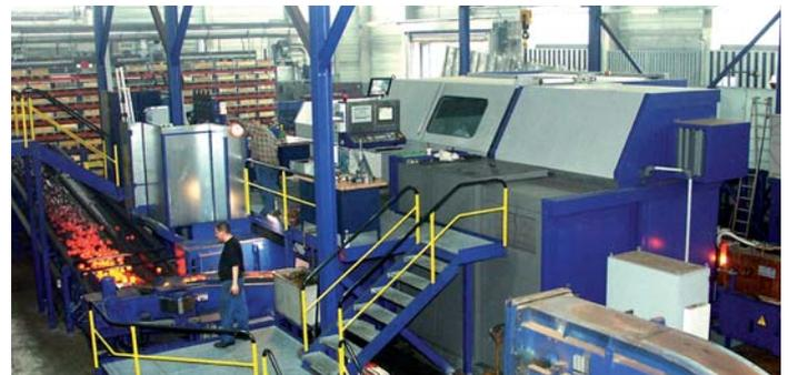
Bild 6: Hatebur Hotmatic HM 45: Mit einem Ausstoß von bis zu 150 Schmiedeteilen pro Minute lässt sich mit der ultraschnellen Warmpresse eine Vielfalt an Präzisionsschmiedeteilen äußerst wirtschaftlich herstellen. Bild: Seissenschmidt
