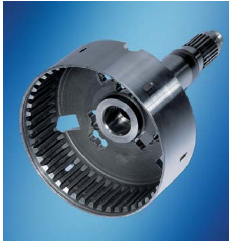
Bild 2: Außenlamellenträger für die Verteilerkupplung allradgetriebener Fahrzeuge mit reduziertem Zerspanungsaufwand. Das Basisbauteil wird zunächst durch eine Halbwarmumformung hergestellt. Die Verzahnungen entstehen in einem anschließenden Kaltumformprozess.
