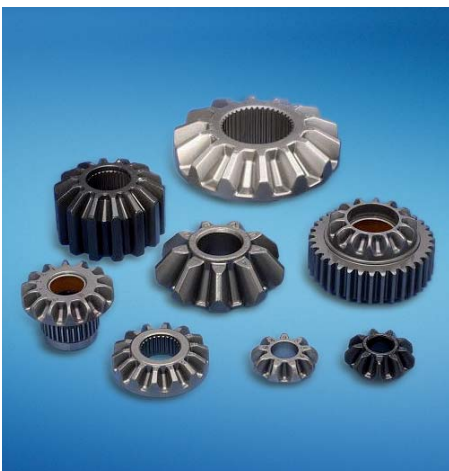
Bild 3: Präzisionsgeschmiedete Zahnräder für Differenziale. Vorteile sind die optimierte Auslegung der Verzahnung, die Integration von Nebenfunktionselementen sowie eine optimale Gestaltung der Zahnfußkontur.
