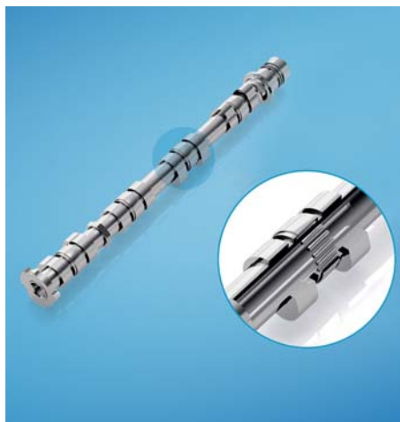
Bild 4: Gewichtsparende gebaute Nockenwelle aus einem Rohr mit aufgedrückten, geschmiedeten Nocken und integrierten einteiligen Wälzlagern. Dadurch um 20 Prozent verringerte Reibungsverluste speziell bei niedrigen Drehzahlen (Start-Stopp-Betrieb von Hybridantrieben). Bild: Neumayer Tekfor
