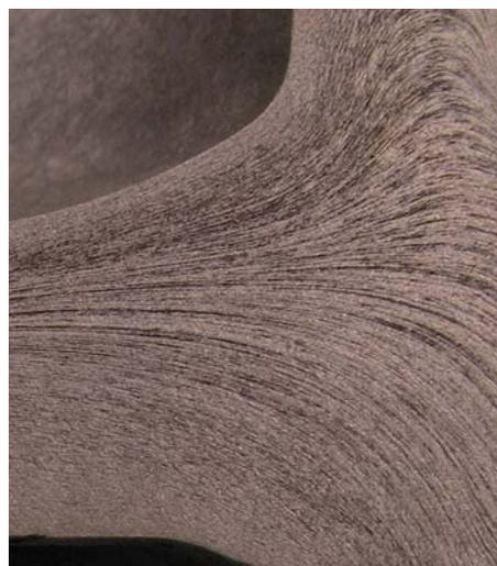
Bild 1: Faserverlauf eines warm massivumgeformten Bauteils – HCl-Ätzung.
