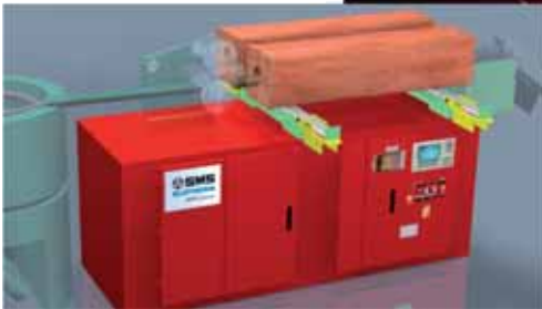
Bild 3: Induktionserwärmer mit erhöhter Rücklauftemperatur. Bilder: Autoren
