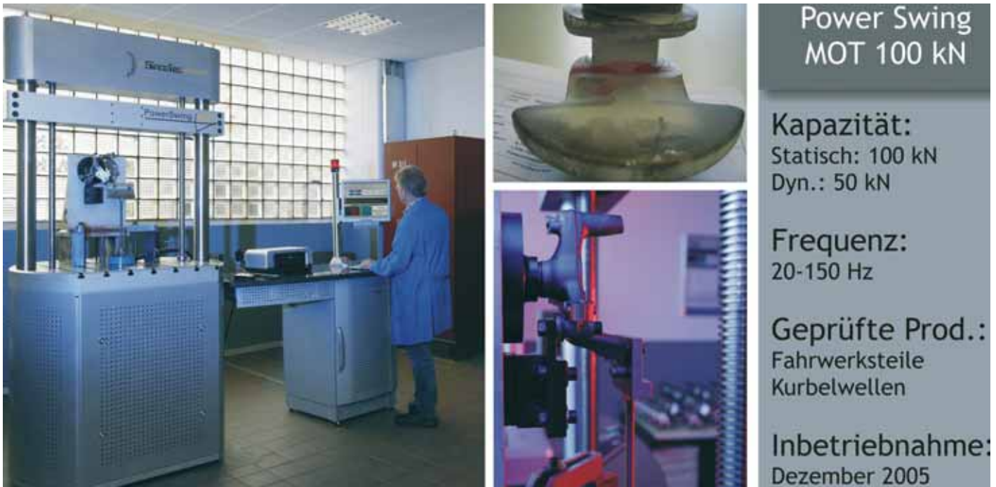
Bild 4: Resonanzprüfstand Power Swing MOT 100 kN (Sincotec) bei CDP BF.
