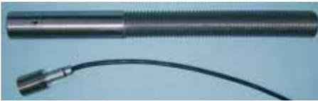
Bild 2: Wirbelstromsensor mit Applikationsvorrichtung für Gesenke.
