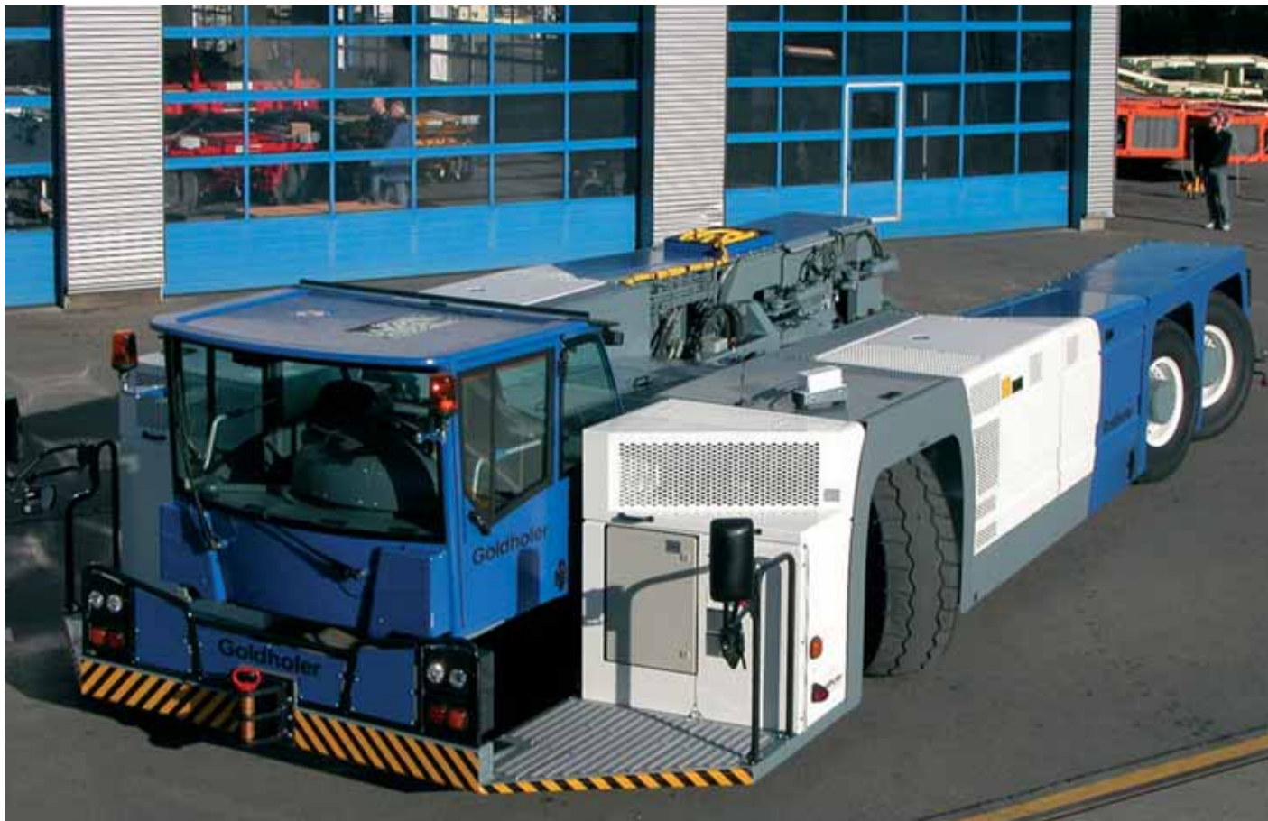
Bild 1: Dank Allradantrieb und Allradlenkung ist der AST-1 sehr wendig und manövrierfähig.
