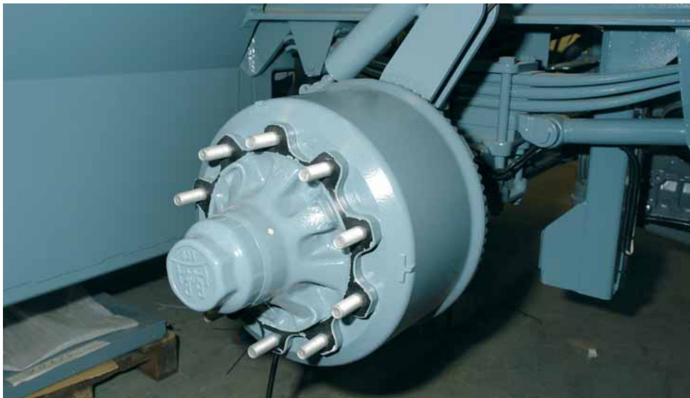
Bild 2: Die massigen Radträger werden von BPW angeliefert und in Memmingen montiert.
