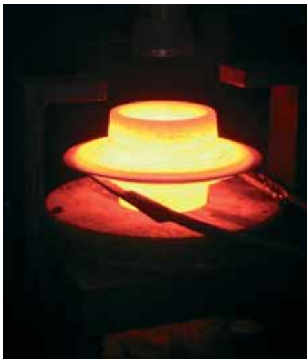
Bild 5: Rohteil für die Radträger sind die Schmiedeteile der Firma Schmiedag GmbH & Co. KG aus Hagen.
