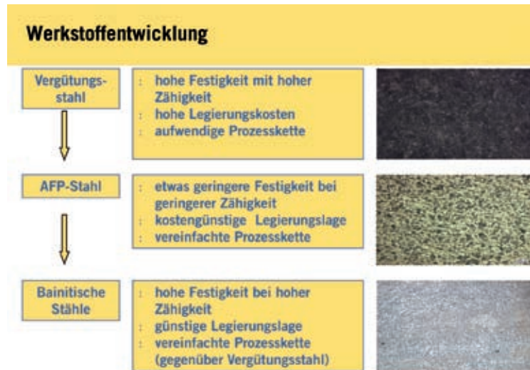
④ Die Werkstoffentwicklung vom Vergütungsstahl bis zu bainitischen Stählen; deren Gefügestand bietet das Potenzial, bei vereinfachter Prozesskette die Eigenschaften von Vergütungsstählen zu erreichen (Bild: Hirschvogel)
