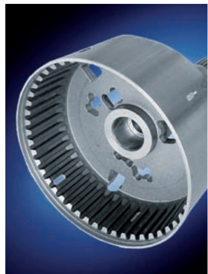
5 Kostenoptimierter Herstellprozess eines Lamellenträgers: vom halbwarm geschmiedeten Basisbauteil über die kalterformt eingebrachte Verzahnung bis zum einbaufertigen Bauteil (Bild: Hirschvogel)
