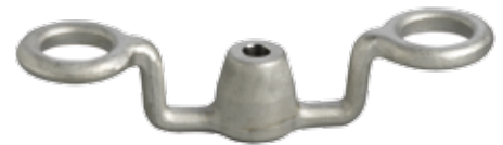
Bild 3: Der filigrane Hängebügel aus Edelstahl wiegt nur 190 g und wird auf einer Spindelpresse gefertigt. Der ununterbrochene Faserverlauf und die belastungsgerechte Materialverteilung gewährleisten maximale Belastbarkeit
