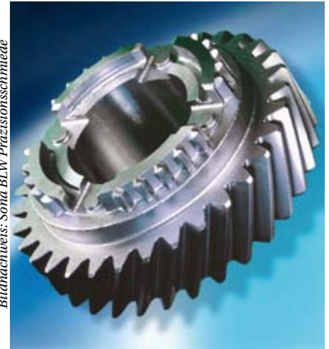
Bild 2: Gangrad für ein PKW-Getriebe. Kuppelverzahnung sowie Mitnehmeraschen wurden einbaufertig geschmiedet, zu bearbeiten waren Laufverzahnung und Bohrung
