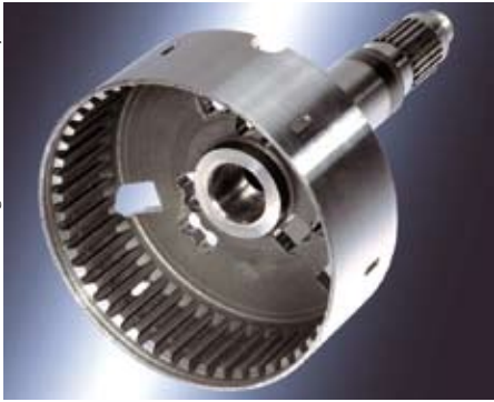
Bild 4: Einbaufertig kaltumgeformte Lamellenverzahnung. Durch die Kaltverfestigung an den Flanken der Verzahnung können weitere Warmbehandlungsschritte eingespart werden. Die Verzahnung wird ohne weitere Nachbearbeitung eingesetzt
