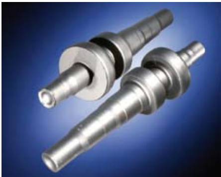
Bild 6: Kalt mit Hinterschnitt umgeformte Getriebewellen. Dieser Verfahrenstrick ermöglicht die Kombination der geringen Aufmaße der Kaltumformung mit weiteren Werkstoffeinsparungen zwischen den Festrädern der Getriebewelle
