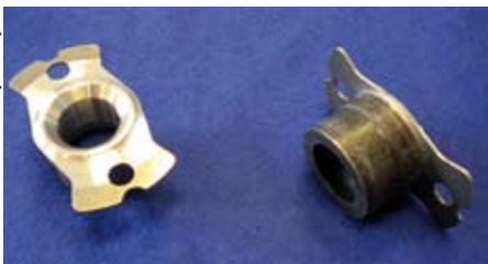
Bild 5: Kaltfließgepresste Lenkradnabe mit einer Flanschdicke von 1mm mit speziell abgestimmten Materialeigenschaften (Faserverlauf und Kaltverfestigung) im Flansch
