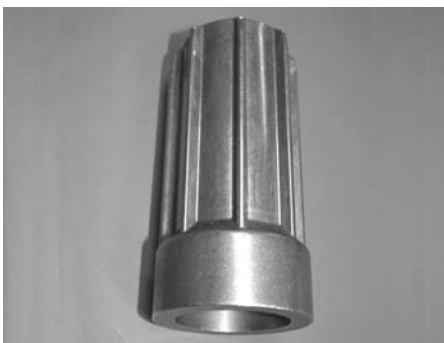
Bild 7: Kaltfließgepresstes Innenteil eines innovativen Dämpfungselements für den Antriebsstrang von heckgetriebenen Fahrzeugen aus C15. Aufgrund der Kaltverfestigung erreicht das Bauteil die geforderten mechanischen Eigenschaften ohne weitere Wärmebehandlung
