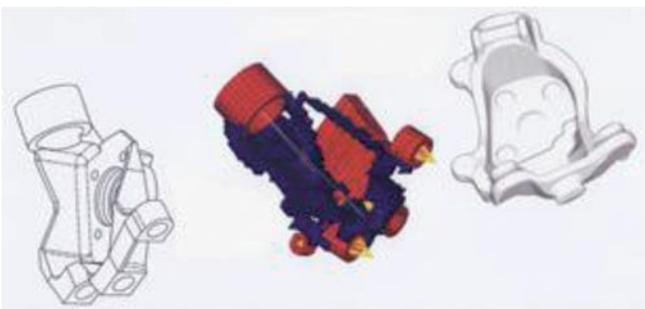
**BILD 3** Topologieoptimierung eines Schwenklagers: Das aus der Kundenidee (links) erzeugte Grobmodell wird im Rechner sukzessive verschlankt (Mitte). Für das Endergebnis berücksichtigt der Konstrukteur noch die Erfordernisse des Schmiedeprozesses (Grafik: Hirschvogel Automotive Group)
