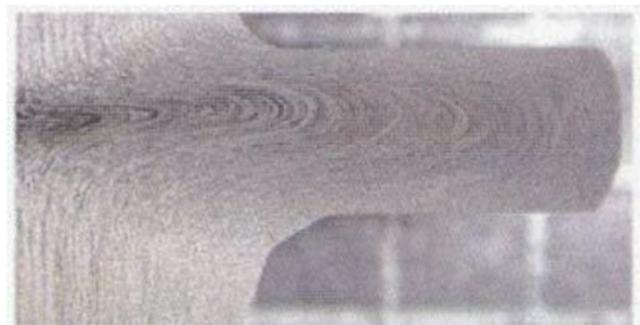
**BILD 5** Der Umformprozess erzeugt im Bauteil eine Faserstruktur, welche die Belastbarkeit in Richtung der Fließlinien des Werkstoffs erhöht (Bild: Hirschvogel Automotive Group)
