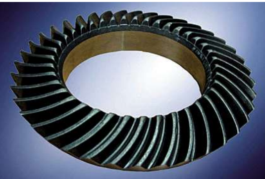
Bild 3: Bei diesem Tellerrad wurde die Verzahnung vorgeschmiedet. Bei einem Durchmesser von 200 mm konnten so rund 70 g Gewicht eingespart werden.
