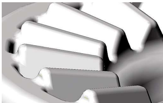
Bild 5: Diese Variante einer Hirth-Verzahnung ließe sich frästechnisch nicht mit vertretbarem Aufwand fertigen.
