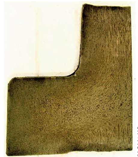
Bild 4: Faserverlauf: Der Schmied steuert den Umformvorgang so, dass die Orientierung der Fasern auch bei Konturversprüngen mit der Hauptbeanspruchungsrichtung des Bauteils übereinstimmt.
