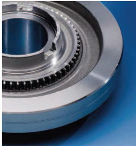
Zahnradrohling mit präzisionsgeschmiedeter Kuppelverzahnung. Vorteile sind die optimierte Auslegung der Verzahnung, die Integration von Nebenfunktionselementen sowie eine optimale Gestaltung der Zahnfußkontur
