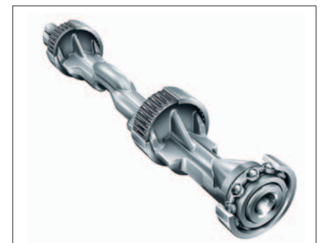
Diese geschmiedete Ausgleichswelle ist 33 % leichter als der gegossene Vorgänger. Induktiv gehärtete Lagerflächen ermöglichen Nadellager ohne Innenring. Bild: Schaeffler KG/Hirschvogel
