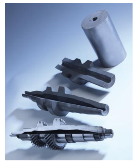
6 Prototyp einer Leichtbau-Getriebehohlwelle und Stufenfolge der Fertigung. Die neuartige Hohlwelle ist mit 5,2 kg um rund 1 kg leichter als die Serienvollwelle. Neben der Verringerung des Fahrzeuggewichts bewirkt die Leichtbauwelle insbesondere eine Reduzierung der bewegten Masse im Fahrzeuggetriebe und damit Einsparvolumen bei der Antriebsenergie. Bild: IWU
