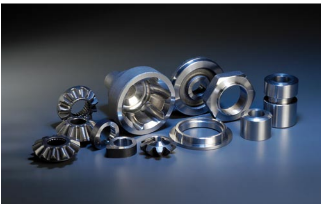
❷ Vielfalt von Umformteilen für die Automobilindustrie. Auf horizontalen Mehrstufenpressen warmumgeformte, zum Teil kaltkalibrierte oder durch zerspanende Bearbeitung auf engste Toleranzen und beste Oberflächenqualitäten weiterbearbeitete Kegelräder, Motornocken, Synchronkonus, Planetenräder und Sicherungsmutter. Bild: Seissenschmidt
