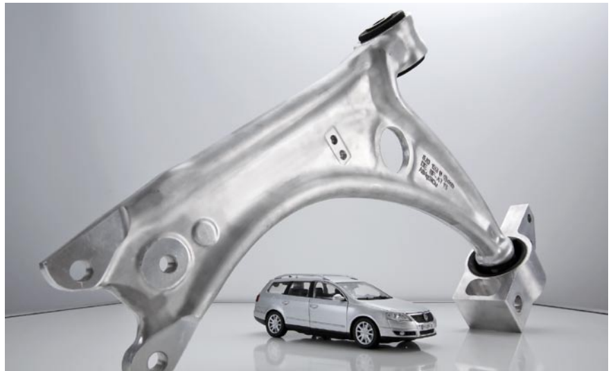
❶ Geschmiedeter Aluminium-Querlenker für den VW Passat, ein hochkomplexes geschmiedetes Aluminiumteil mit hoher Festigkeit. Vor dem eigentlichen Schmiedevorgang wird das Aluminiumbauteil in einem patentierten Stauchprozess vorgeformt. Durch dieses Stauchen wird eine Materialanhäufung erzielt, bei der eine Vorform entsteht, die im Biege- und Pressvorgang besonders Material einsparend weiterverarbeitet werden kann. Bild: Bharat Forge Aluminiumtechnik
