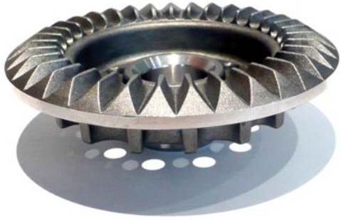
4 Aus der Serienfertigung von Getriebebauteilen: Komplexes hochfestes präzisionsgeschmiedetes Differenzialgetriebebauteil für eine Pkw-Anwendung (Kronrad). Basis sind wirtschaftliche Umformverfahren und Verfahrenskombinationen bis hin zu einbaufertigen Komponenten für den Pkw- und Lkw-Bereich. Schwerpunkt ist die Kombination von Verfahren der Warm-, Halbwarm- und Kaltumformung. Bild: Sona BLW Präzisions schmiede
