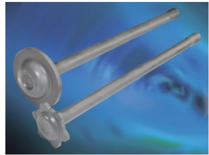
⑨ Im Stauchprozess hergestellte Achsteile für Nutzfahrzeuge. Mit Waagrecht-Stauchmaschinen und einem stetig verbesserten Verfahren werden hohe Genauigkeiten erzielt bei Schmiedeteilen im Gewichtsbereich von 5 bis 40 kg. Das Bild zeigt entsprechend den Flanschformen als Schirm- beziehungsweise Sternwellen bezeichnete Teile, die nach einer partiellen Induktiverwärmung in vier Umformstufen gefertigt werden. Bild: GKN Driveline
