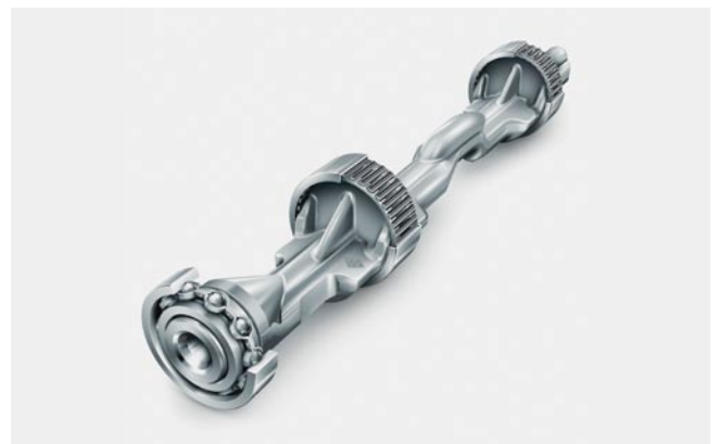
❸ Zwei geschmiedete wälzgelagerte Ausgleichswellen sorgen in Vier-Zylinder-Diesel-Reihenmotoren für ruhigen Lauf. Stahl statt Guss ermöglicht die Funktionsintegration, die minimierte Laufbahnbreite reduziert die Masse, Wälz- statt Gleitlager verringern die Reibung. Das bedeutet für den Fahrbetrieb reduzierte Antriebskräfte, weniger CO 2 -Emissionen und geringere Geräuschentwicklung. Bild: Hirschvogel
