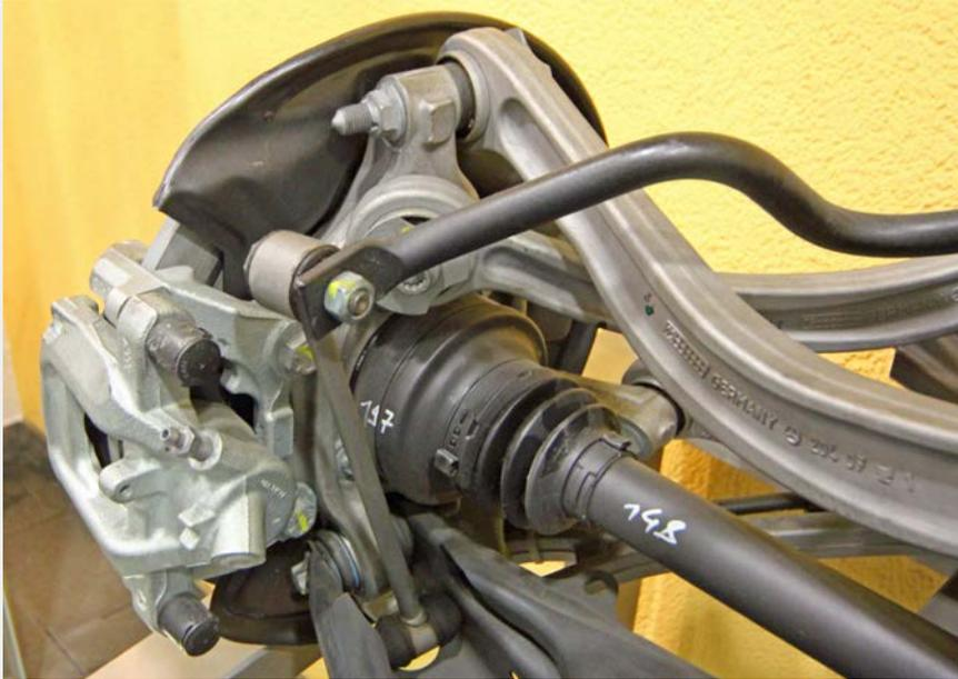
**Bild 5:** PKW-Achse mit Schmiedeteilen aus Aluminium bzw. aus Stahl
