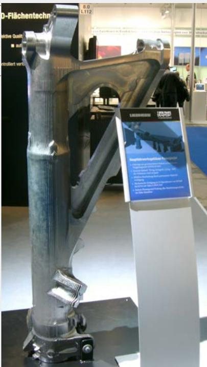
**Bild 2:** Teilweise bearbeiteter Schmiederohling aus hochfestem Vergütungsstahl für das Hauptfahrwerksgehäuse eines Passagierflugzeugs
