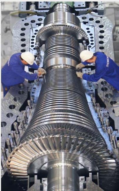
**Bild 1:** Kraftwerksturbine mit geschmiedeter Welle
