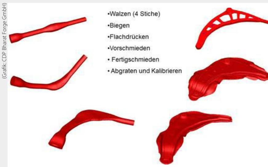
**Bild 7:** Der Rohling muss vor dem Schmiedevorgang in mehreren Stufen umgeformt werden
