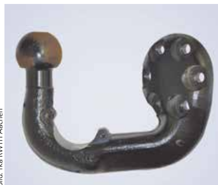
Bild 3: Anhängerkupplung aus hochfestem, duktilem Bainitstahl.
