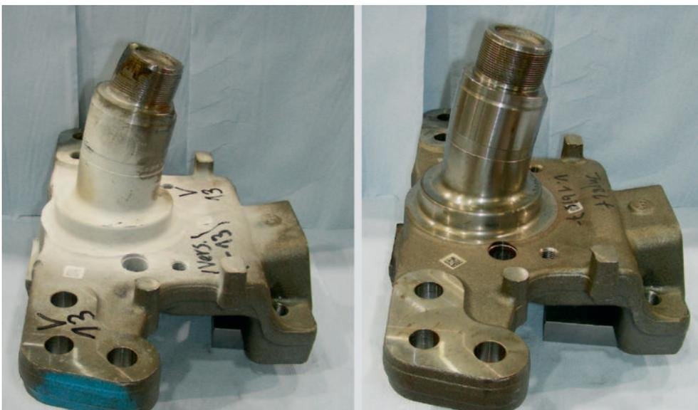
BILD 5 Verformte Achsschenkel: AFP-Stahl vs. Vergütungsstahl nach Impactversuchen bei -40 °C (links: 18MnV5 BY, rechts: 38MnB5 V)
