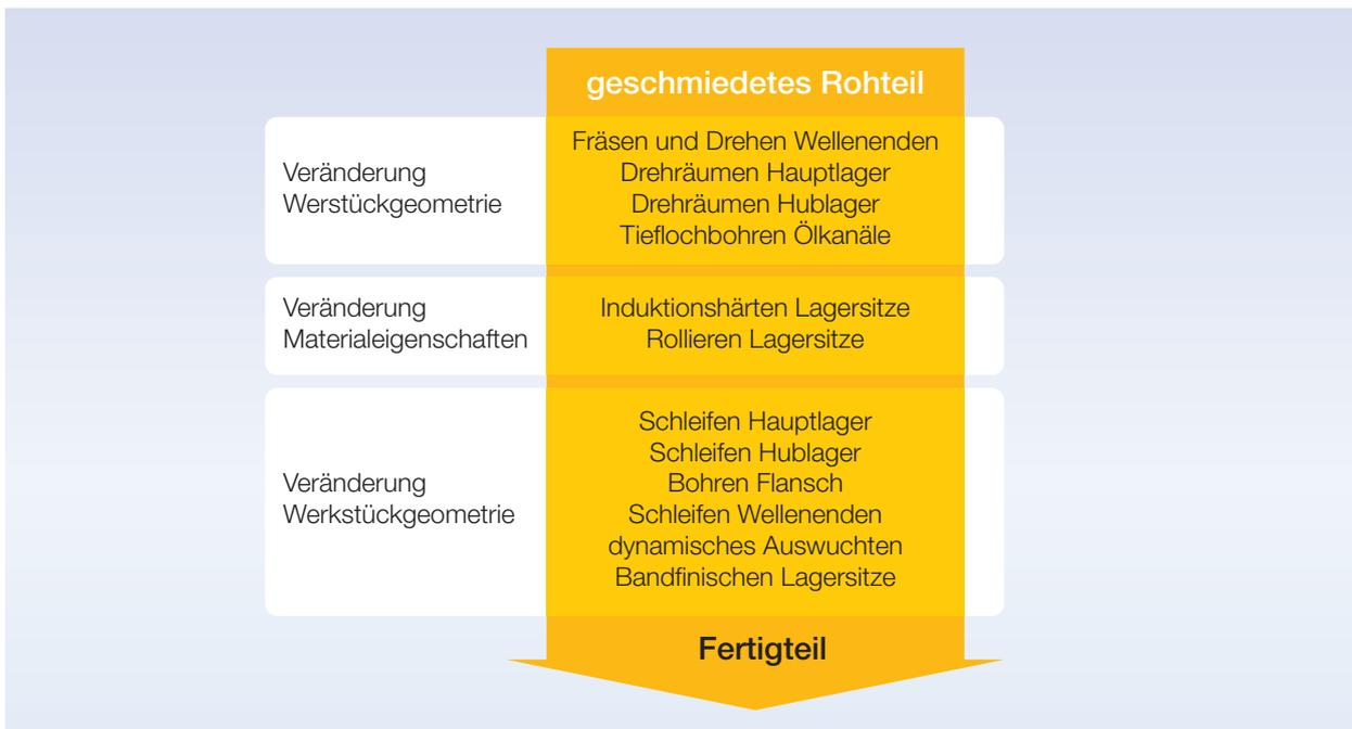
Bild 7.20: Prozesskette zur Herstellung von Kurbelwellen (nach J.C. Becker).
