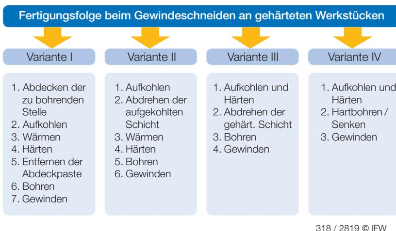
Bild 4.19: Reduzierung der Arbeitsschritte beim Gewindebohren.
