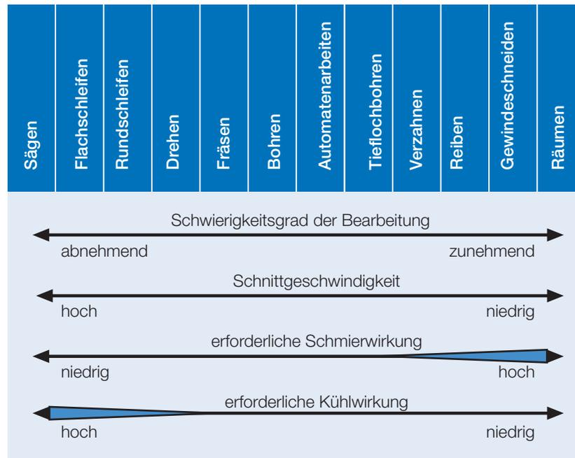
Bild 2.40: Anforderungen spanender Verfahren an Kühlschmierstoffe.
