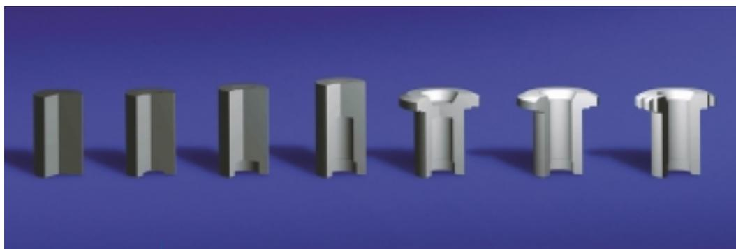
Bild 3: Stufenfolge zur Herstellung eines hohlen Kaltfließpressteils mit Verzahnung
