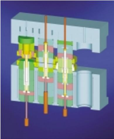
Bild 4: Dreistufiges Umformwerkzeug zur Herstellung von Getriebewellen
